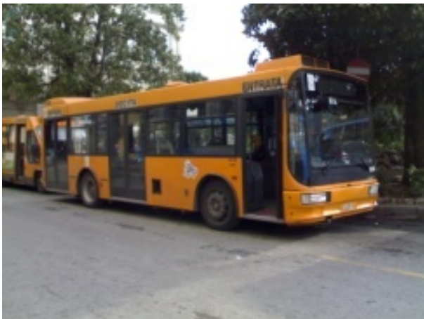
FIGURA 2.12 Cacciamali TCM890 n°534 della serie 531-534 del 1997: sono i primi autobus a pianale ribassato
