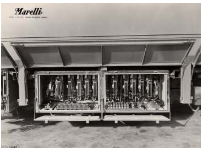
FIGURA. 4.07 Apparecchiature elettriche di un Alfa Romeo 140 AF Stanga, serie 521 - 523 dell'A.T.M. Milano (Foto Marelli)
