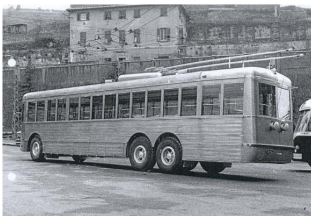
FIGURA.4.05 Filobus Alfa Romeo - Piaggio con cassa Inox del 1942, ex A.T.A.G. Roma 9001, all'interno dello stabilimento Ansaldo di Genova (foto Ansaldo)
