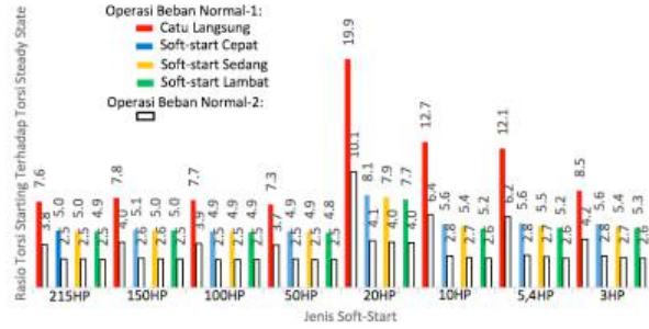
Gambar 15. Reduksi Lonjakan Torsi Starting Oleh Unit Soft-Starter Untuk beban Normal-1 dan Beban Normal 2
