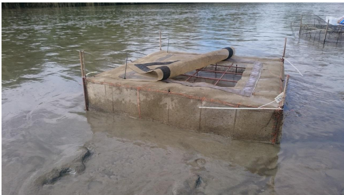
Figuur 7: Exclusure type "2M" geïnstalleerd op de Notelaer, eind juli 2017.
