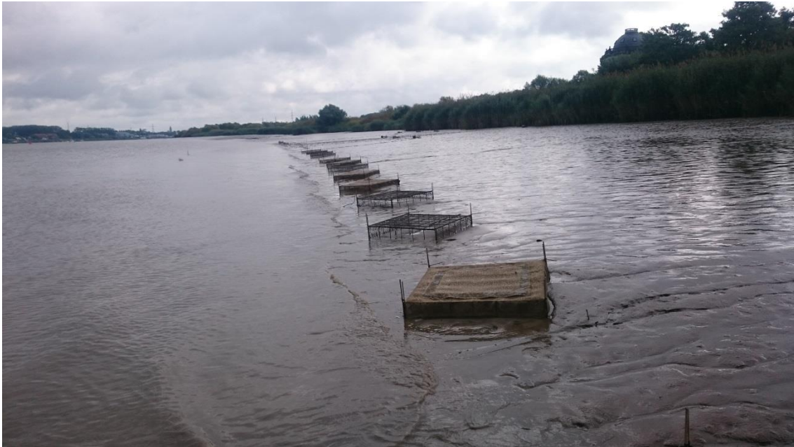
Figuur 9: Zicht op een deel van de experimentele opstelling op de Notelaer (3 augustus 2017). Alle experimentele plots staan op dezelfde hoogte ten opzichte van de waterlijn (hier bij opkomend tij net tot aan de kooien).
