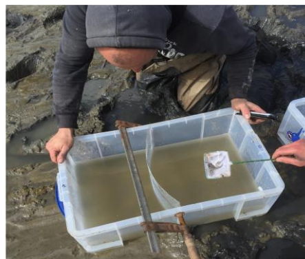
Figuur 5: Schematische weergave van testconstructie en terreinimpressie van dezelfde opstelling om doorlaatbaarheid van netstof voor predatoren te testen.
