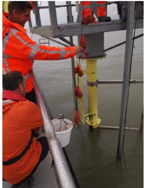
Figuur 2 Voorbeelden van het uithangen van de mosselen. Bevestiging van de mosselen aan het koord (links) met schakels als gewichten, uithangen van een koord aan een meetpaal met een cementanker om het koord strak te houden (rechts).
