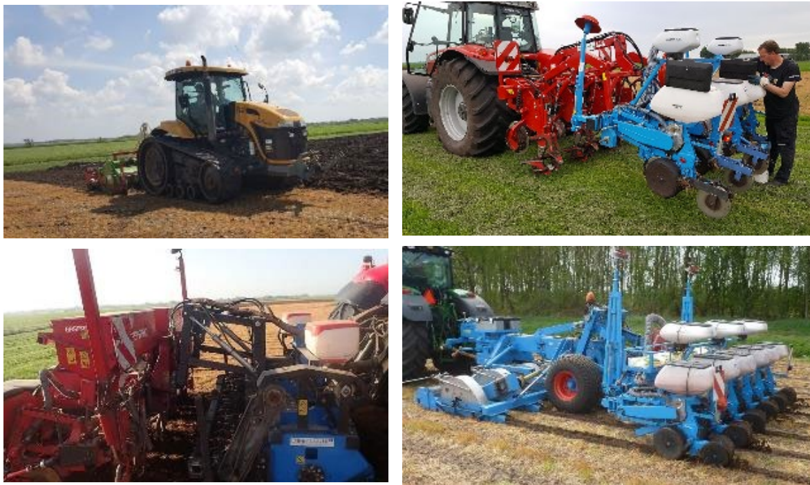
Figuur 4. Gebruikte machines. Van linksboven naar rechtsonder: Overtopfrees, strokenfrees Hoekstra, strokenploeg Hielkema, strokenfrees Zandvliet. Voor strokenfrees BUMA zie Figuur 3.
