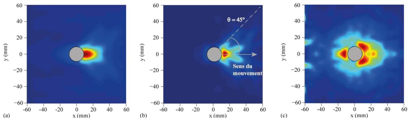
Fig. 3 – Champ des contraintes normales  $p$  (a), des contraintes tangentielle  $\tau_{VM}$  (b) et des taux de déformations  $\dot{\gamma}_{VM}$  (c) dans l'empilement autour de l'intrus de diamètre  $d = 16$  mm. Les zones rouges (resp. bleues) correspondent aux zones de fortes (resp. faibles) valeurs.
