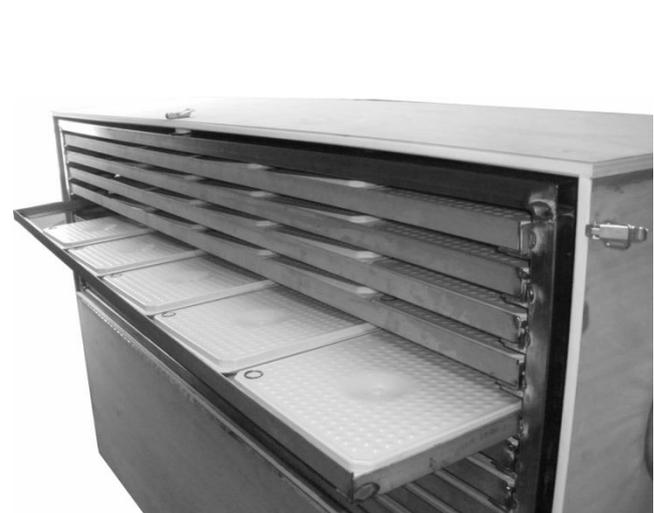
FIG. 2 : Photographie de l'échangeur-stockeur ouvert.
