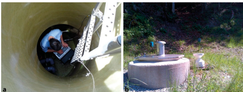
Abb. 1 Auslesen der Messinstrumente (links) sowie Aufbau einer Niederschlagsmessung bei einem Quellsammelschacht (rechts)
