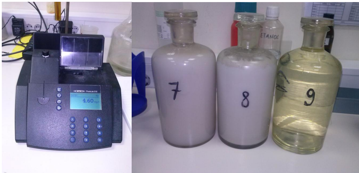
Slika 34: Fotometer WTW Photolab S12 in vzorci vode iz vtoka, delovne posode in iztoka
