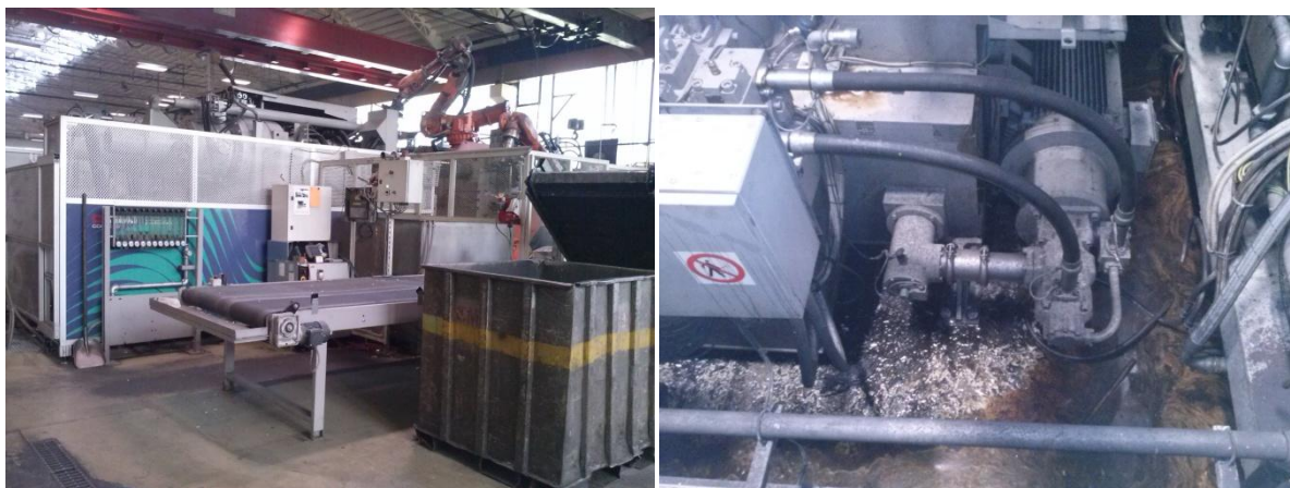
Slika 9: Livarski stroj in voda, ki se zbira pod livarskimi stroji
