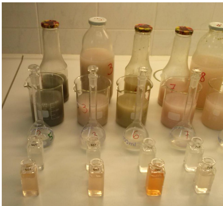
Slika 33: Ugotavljanje koncentracije železa v OV pod livarskimi stroji
