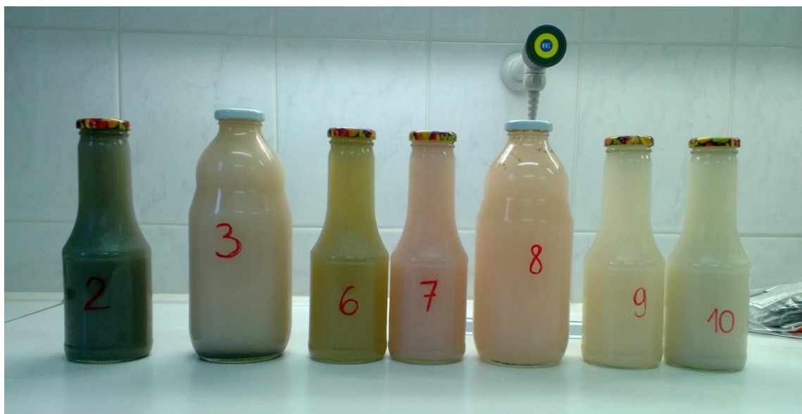
Slika 31: Vzorci odpadne vode izpod livarskih strojev
