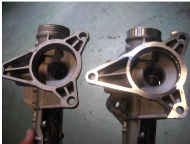
Slika 11: Razlika med peskanim in mehansko obdelanim izdelkom
