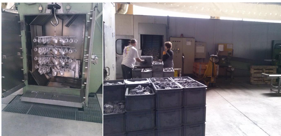
Slika 10: Prikaz postopkov: peskanje in rotovibriranje
