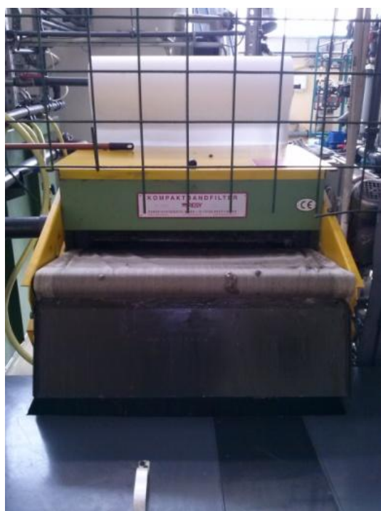
Slika 19: Avtomatski tračni filter
