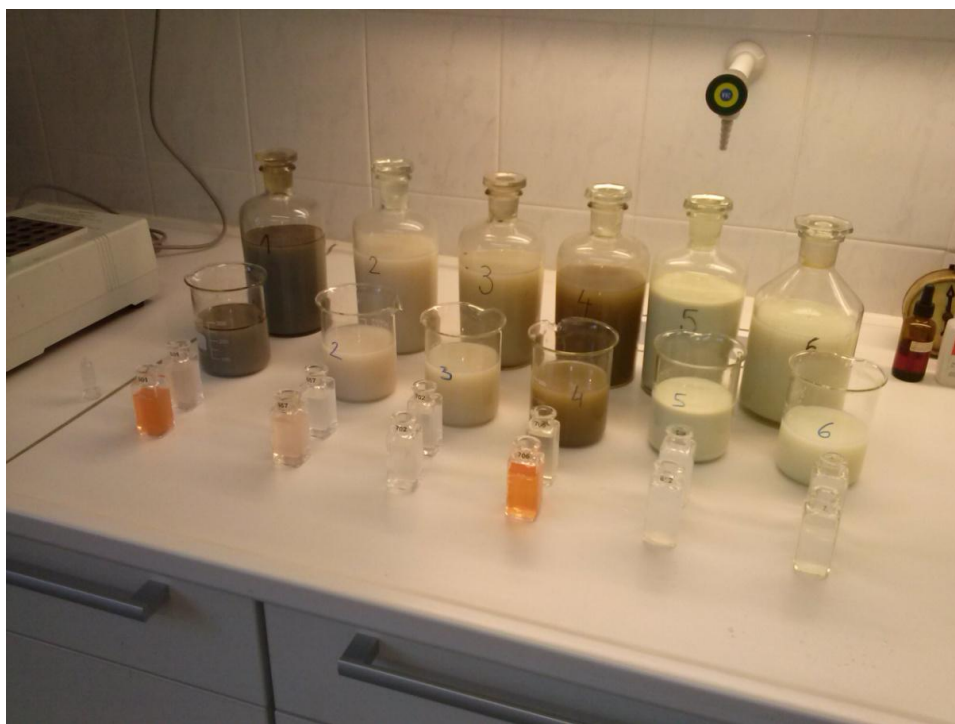
Slika 29: Potek meritev koncentracije železa v posameznih vzorcih
