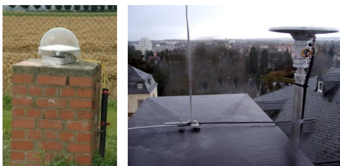
Slika 23: Stabilizacija anten za točko KLOP (levo) in BADH (desno) (EPN, 2013)
