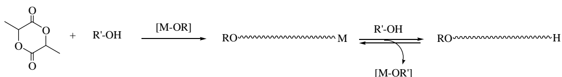
Schéma 29. Croissance simultanée de plusieurs chaînes de polymère par centre métallique grâce à un agent de transfert.
