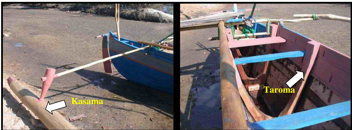
Figure 21 : Bois utilisé dans la construction du bateau (Photos : C. Andriamalala)
