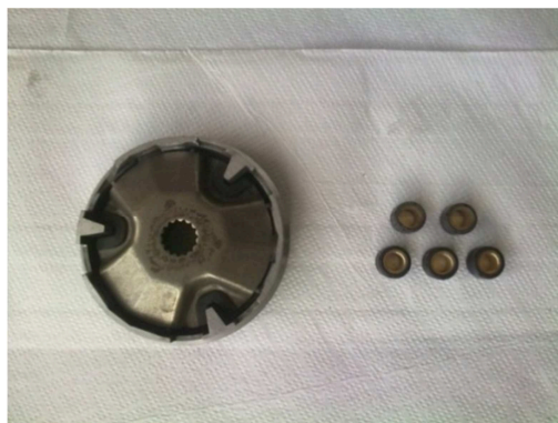
Obrázek 51: Variátor a válečky
