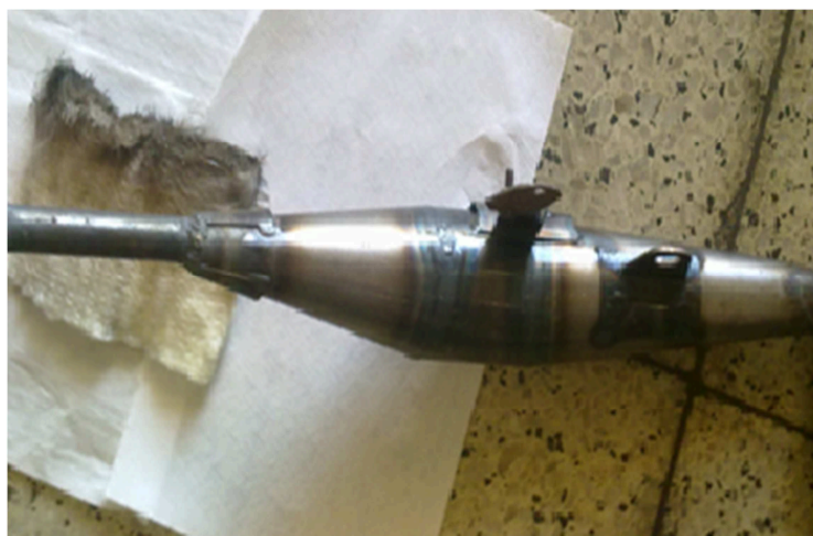
Obrázek 43: Vlastní výfuk před dokončením
