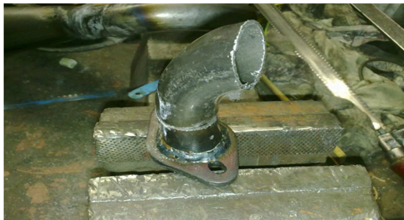
Obrázek 40: Výroba příruby výfuku
