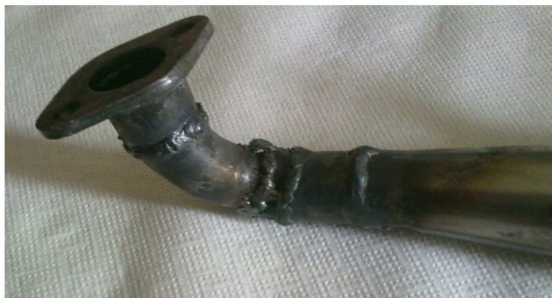
Obrázek 41: Vyrobená příruba výfuku
