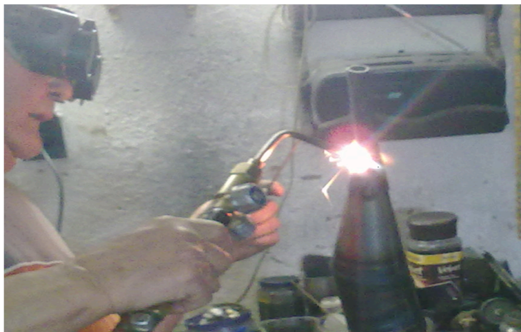
Obrázek 42: Výroba trubičky výfuku
