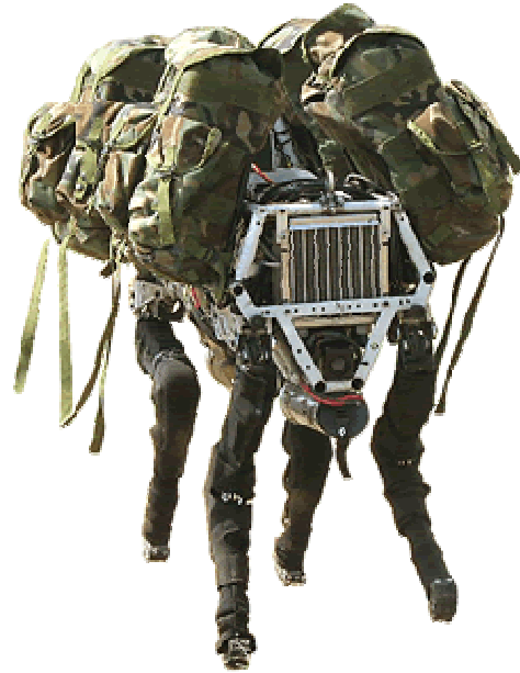
Fig. 7. BigDog - Boston Dynamic's legged UGV.
