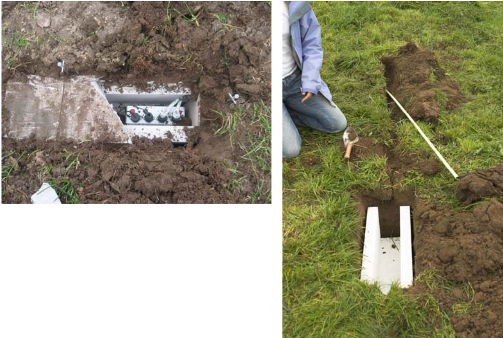
figuur 4 Plaatsing redox sonde (rechts, achterin). Deze redox sonde is gekoppeld aan de HYPNOS logger (links).
