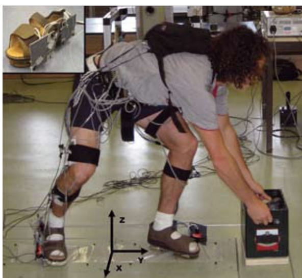
Afbeelding 5. Validatie-experiment voor het meten van grondreactiekrachten met krachtschoenen. Metingen met krachtschoenen werden vergeleken met de metingen van krachtenplatforms
