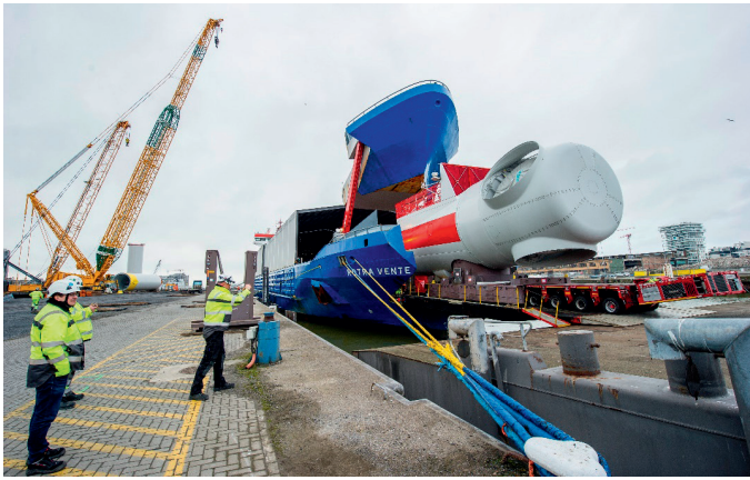
De 'Rotra Vente' is een transportschip met een uitschuifbare boeg (roll on – roll off principe) Het schip vervoert kostbare onderdelen van windmolens die een bescherming tegen weersinvloeden en zeewater vereisen, zoals nacelles en wieken. © Haven Oostende
