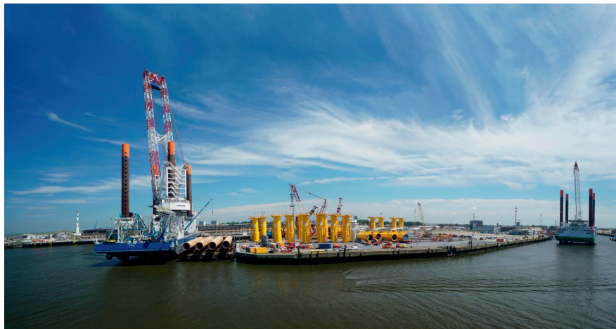
De overgangsstukken voor het 'Nobelwind' windpark worden op het jack up vessel 'Vole au Vent' (Jan De Nul) geladen (links). Rechts ligt de 'Thor' (DEME). © Haven Oostende
