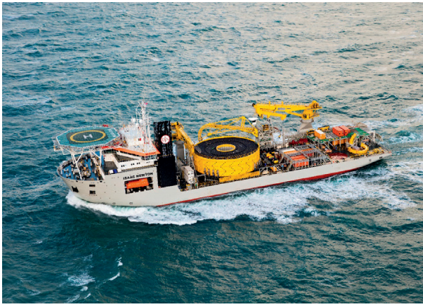
De kabellegger en sleuvengraver 'Isaac Newton' (Jan de Nul) is een speciaal uitgerust schip dat beschikt over een trommel om de elektriciteitskabel te vervoeren en voorzichtig op de zeebodem in te graven. © Jan de Nul
