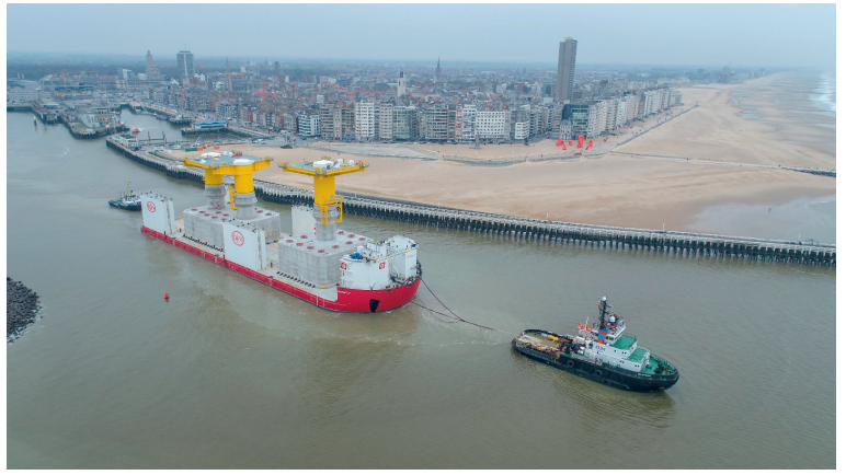
Export vanuit de haven van Oostende: het varende ponton 'Boobarge 37' transporteert twee gravitaire funderingen voor een Deens windpark. © Haven Oostende
