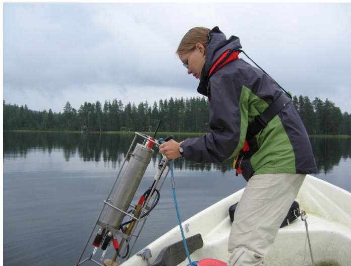
Kuva 4.9: Mittaamassa CTD90M-luotaimella Petäjävedellä
