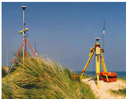
FIGURE 1.7 – Système de positionnement géodésique
