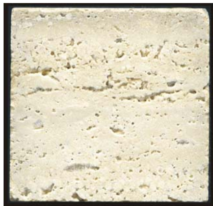
Fig. 2.- Muestra de Travertino Clásico (aristas de 5cm) con predominio de estructura criptobandeada, resaltada por porosidad fenestral.
