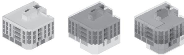
Fig. 5. Diferencias entre los conceptos de envoltente del edificio, envoltente térmica y envoltentes acústicas en un edificio plurifamiliar.
