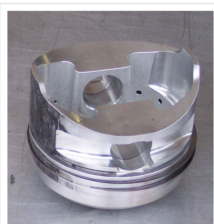
Foto de un pistón desde su parte inferior. Se observan los segmentos y los orificios que alojan al eje de la biela.
