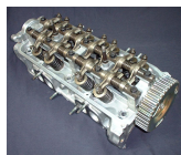
Culata con árbol de levas de un motor Honda D15A3.
