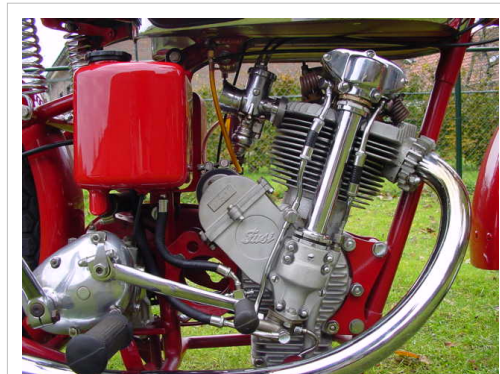
Motor SOHC de moto de competición, refrigerado por aire, 1937
