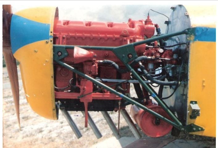
Motor de aviación antiguo, se aprecia el cárter en negro y el bloque motor y culata en rojo
