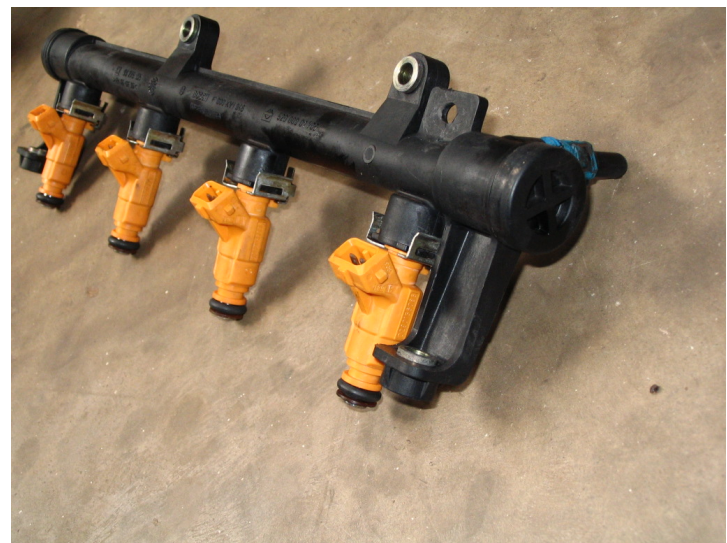
inyectores de inyección de gasolina, con su rampa de alimentación
