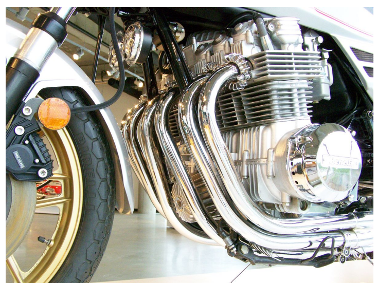
cárter estructural de aleación, de una Benelli "Sei"
