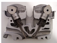
Culata cortada, mostrando las válvulas y puertas de admisión y de escape, canales de refrigeración, taqués, etc.
