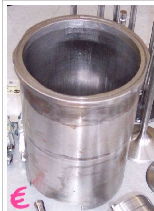
Camisa del cilindro de un motor.
