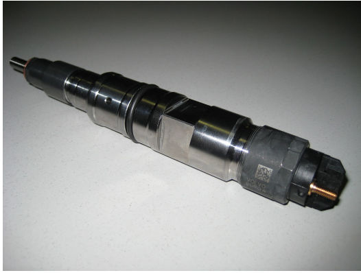
inyector "common rail" de mando electrohidráulico
