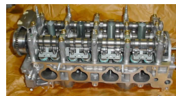
Árbol de levas doble de un motor Honda K20Z3.
