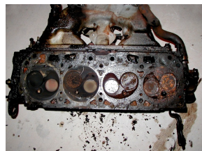
Culata de un GMC van. Se ven las válvulas y parte de del colector de escape.
