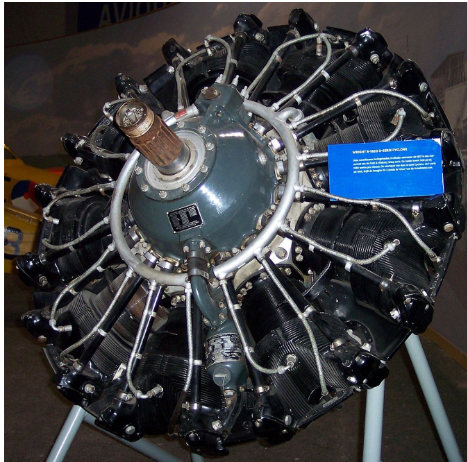
Motor antiguo, de aviación, con disposición radial de los pistones.
