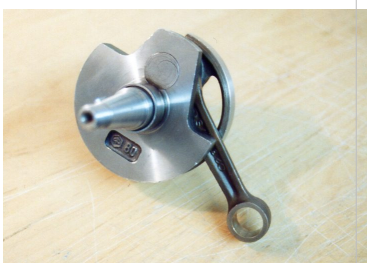
Cigüeñal desmontable de un motor de 2 tiempos monocilíndrico (Piaggio)
