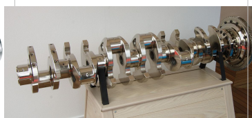
Cigüeñal de un motor de barco con 6 cilindros en línea, con 7 apoyos
