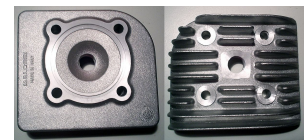
Culata Morini de un scooter (motor de dos tiempos). Agujeros para bujía y 4 tornillos.
