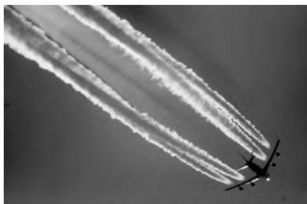
FIGURE II.1 – Régime du jet. Les quatre jets s'enroulent autour des deux tourbillons. Le halo lumineux au centre du sillage a été étudié par [Kärcher *et al.*, 2009; Gierens *et al.*, 2009].
