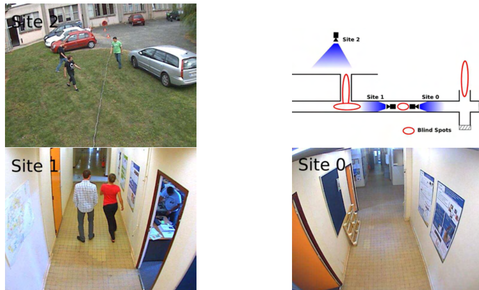
FIGURE 1.3 – Exemple de réseau de caméras à champs de vue disjoints déployé dans un bâtiment et en zone extérieure, présentant de forts changements de point de vue, avec la position des caméras illustrée sur un plan du bâtiment.
