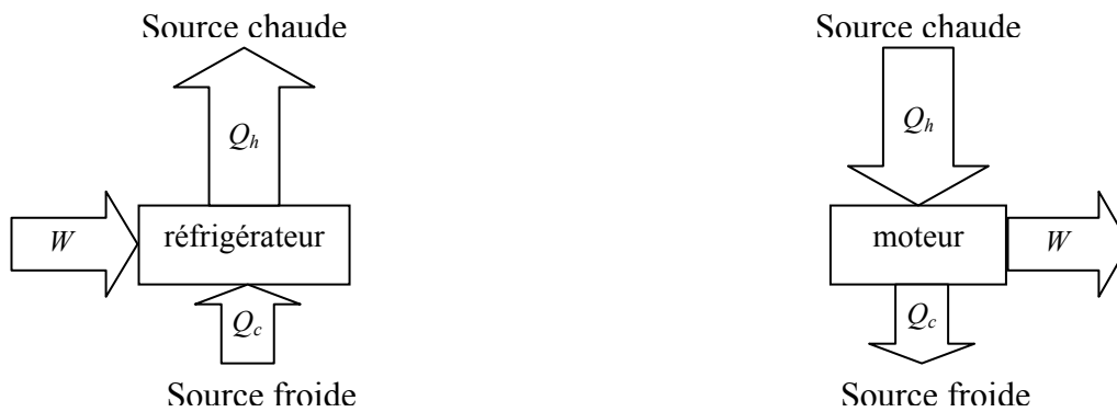
figure I.4 Modes de fonctionnement d'une machine thermoacoustique : réfrigérateur et moteur.
