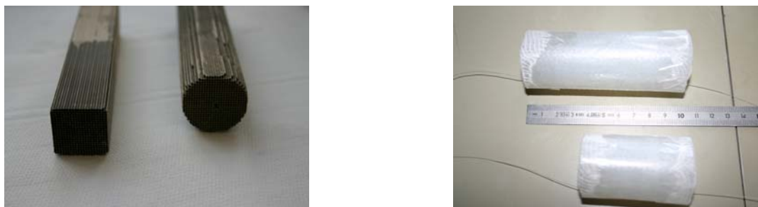
figure.i.2 : Stacks utilisés dans le réfrigérateur du laboratoire PHASE, cordiérite à droite et aérogel de silice à gauche.
