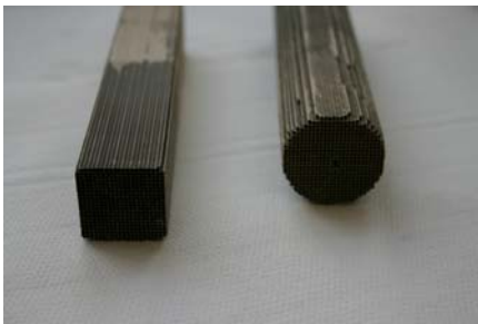
figure I.1 Stacks utilisés dans le réfrigérateur du laboratoire PHASE, cordiérite à droite et aérogel de silice à gauche.
