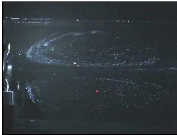
figure.i.3 : Ecoulement engendré par Eckart streaming dans une cavité, f=800 kHz, visualisation effectuée par V. Botton et C. Cachard au LMFA, ECL Lyon.
