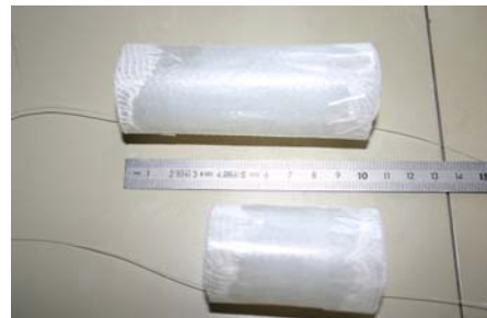
figure I.1 Stacks utilisés dans le réfrigérateur du laboratoire PHASE, cordiérite à droite et aérogel de silice à gauche.
