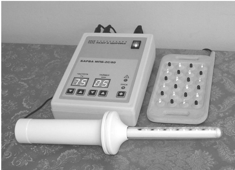
Рисунок 11.11 – Зовнішній вигляд двоканального мікропроцесорного блока імпульсного керування МПБ-2С/80
