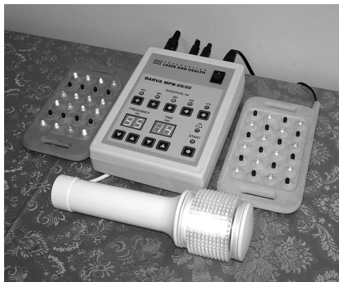
Рисунок 11.16 – Зовнішній вигляд п'ятиканального мікропроцесорного блока імпульсного керування МПБ-5С/20
