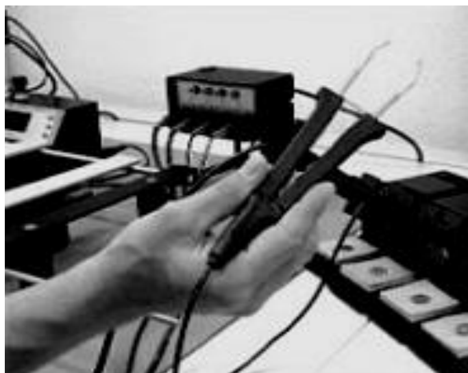
Рисунок 7.15 – Паяння компонентів плати в обмеженій зоні
