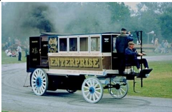
Рис. 8.10. Омнибус «Enterprise» Уолтера Хэнкока, 1833 г. Скорость 32 км/ч, запас хода 32 км
