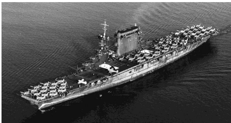
Рис. 11.6. Авианосец «Лексингтон», США, 1927 г. Длина 270,6 м, ширина 32 м, осадка 7,5 м, водоизмещение 33 000 т, бронирование: борт 178 мм, палуба – 76 мм; вооружение: 8 203-мм орудий и 12 127-мм, 78 самолетов. Силовая установка турбоэлектрическая, четырехвальная, мощность 180 000 л.с.; скорость 33 узла, дальность плавания 12 000 миль, при скорости 14 узлов.
