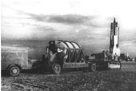
Рис. 12.12. Доставка жидкого кислорода на стартовую позицию, 1948 г.
