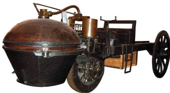
Рис. 8.8. Паровая повозка Кюньо
