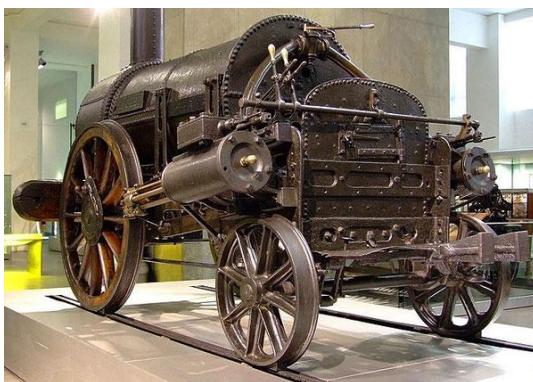
Рис. 8.14. Паровоз Стефенсона «Ракета»
