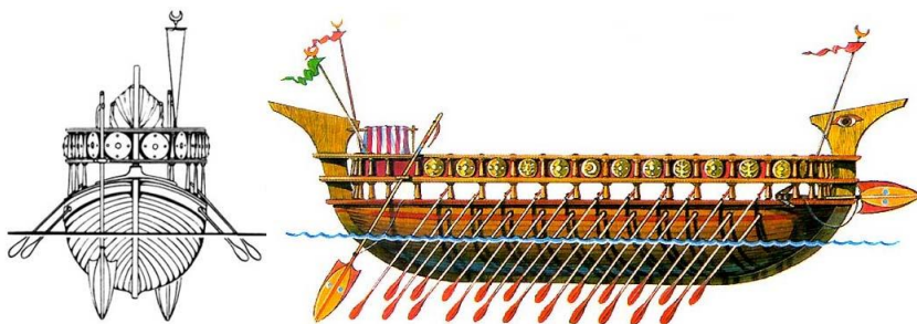
Рис. 2.9. Ассиро-финикийский боевой корабль, 1500 – 1000 г. до н. э. Палуба для воинов поднята на стойках в виде платформы и закрыта фальшбортом, на который навешивались щиты воинов.
