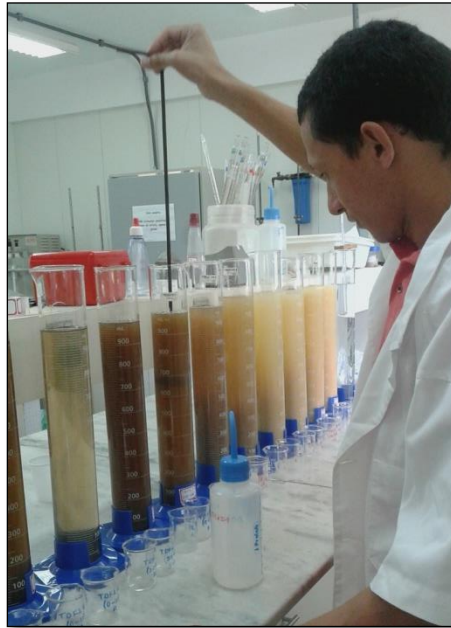
Figura 11 – Agitação das partículas do solo na pipeta para a coleta de silte e argila.
