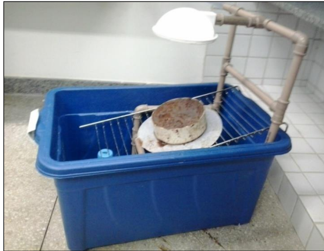
Figura 12 – Ensaio de Inderbitzen (ensaio da cadeirinha)
