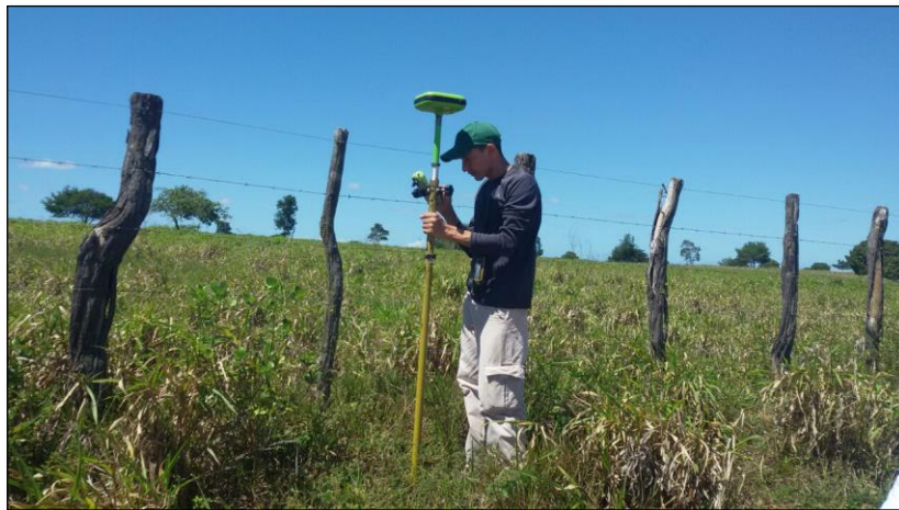
Figura 08 – Levantamento do perfil das unidades naturais através do método RTK.
