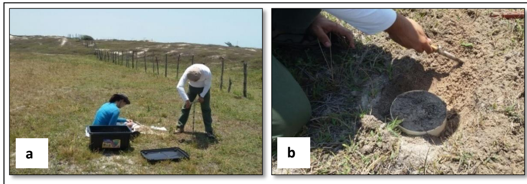
Figura 10 – Coleta de amostras com trado (a) e de amostras indeformadas (b).
