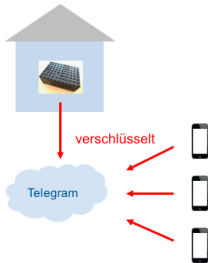
Abbildung 1: Kommunikation eines iCareBot mit Smartphones
