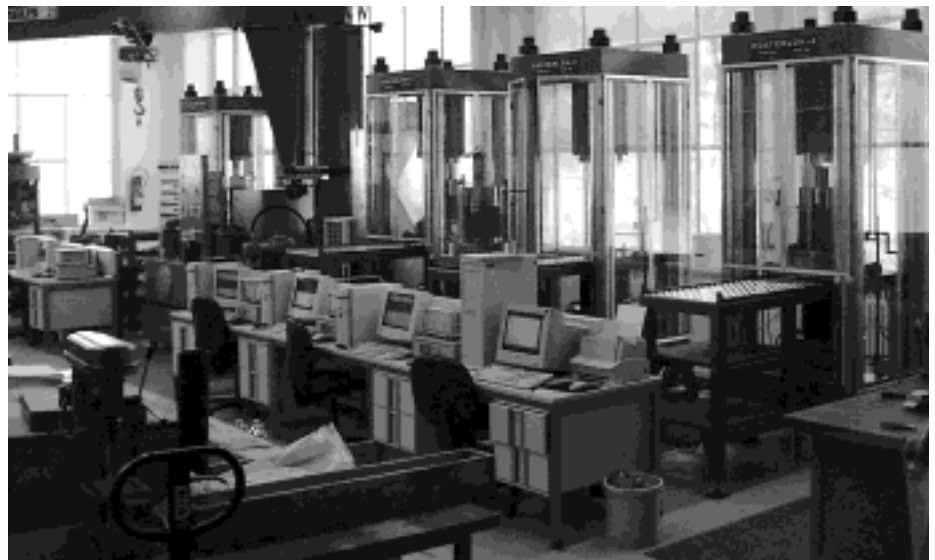
Bild 6: Prüfstände für triaxiale Festigkeits- und Kriechversuche
