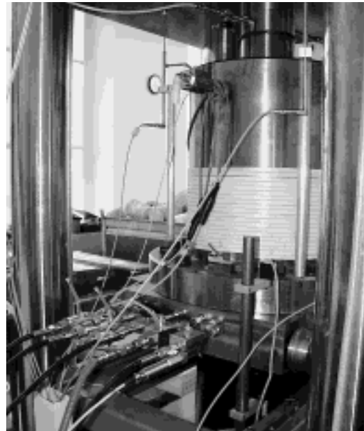
Bild 19: Modellprüfstand für triaxiale TC- und TE-Versuche an axialgelochten Großbohrkernen
