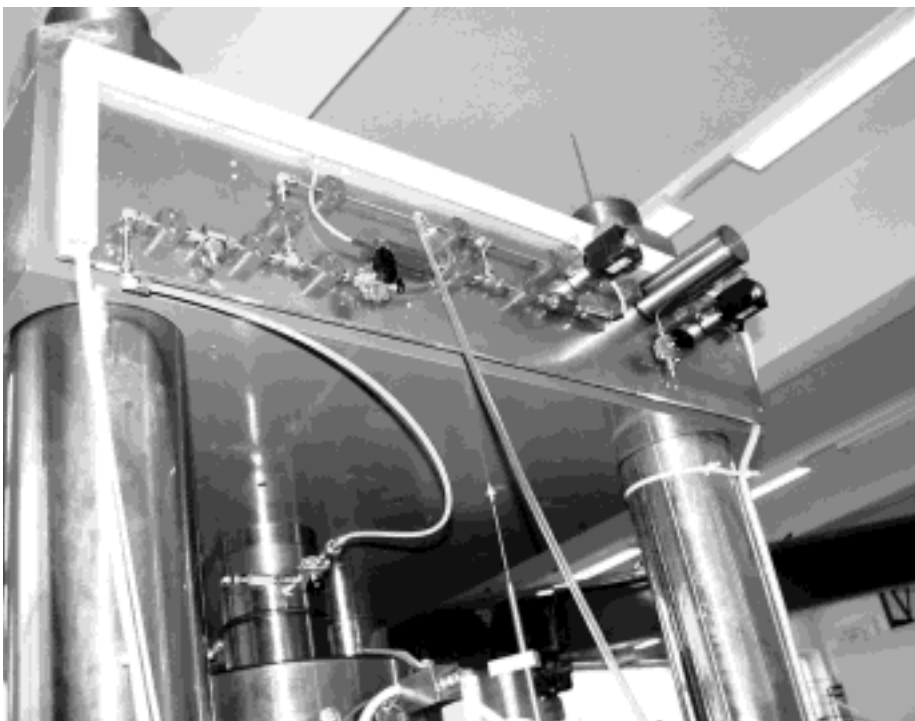
Bild 18: Meßsystem zur Ermittlung von Gasflüssen in Triaxialversuchen
