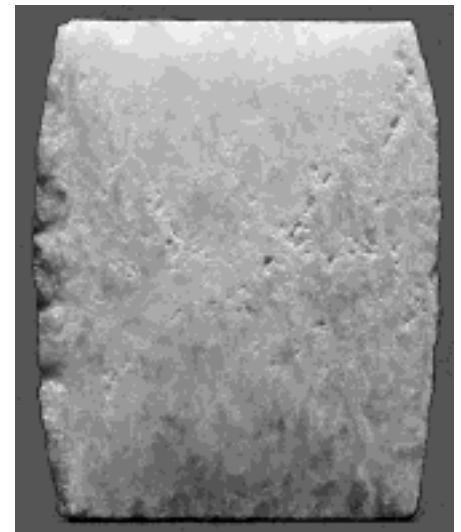
Bild 15: Aufgelockertes und entfestigtes Mineralkorngefüge eines Steinsalzprüfkörpers unter TC-Beanspruchung
