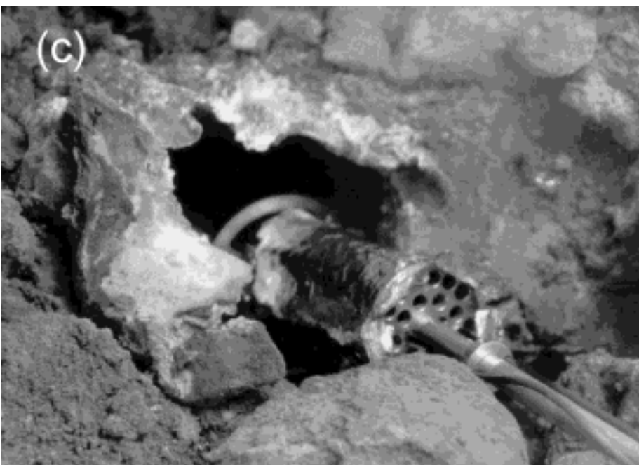
Bild 4c: Einsatz des Sensors direkt im Gasstrom der Fumarole
