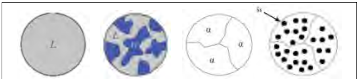
Figure 1.9 Solidification lente d'un alliage d'aluminium-silicium contenant moins de 1,65 % de silicium. Adapté de (Baïlon & Dorlot, 2000; Campbell, 2006)
