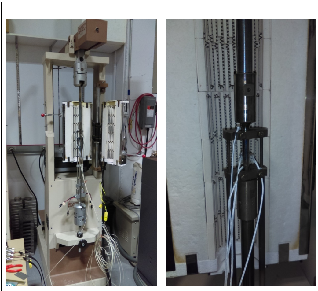
A IV-9 : Banc de fluage modifié et éprouvette installée
