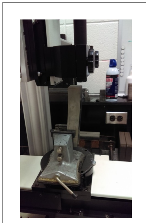
A V-2 : Mesure des déplacements avec le profilomètre
