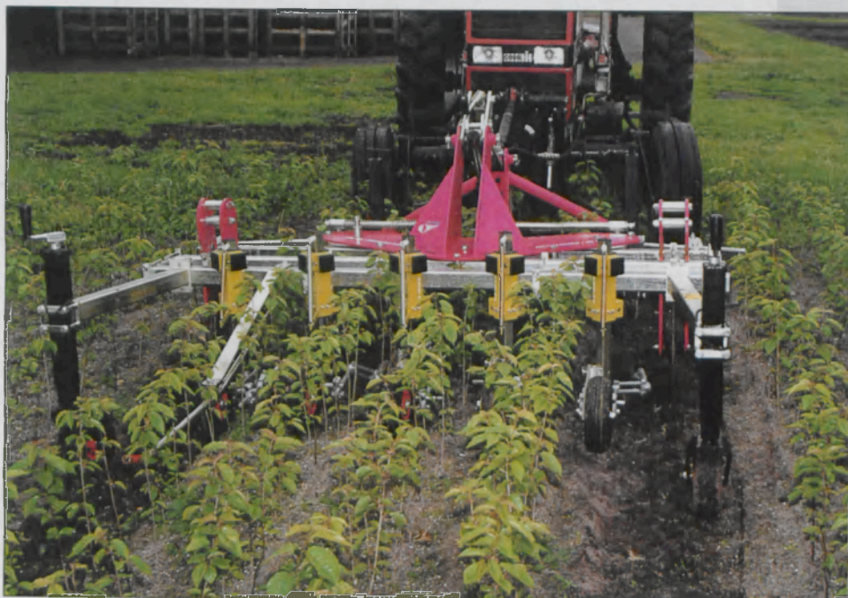
Nieuw schoffelsysteem met een zeer nauwkeurig besturingsmechanisme
