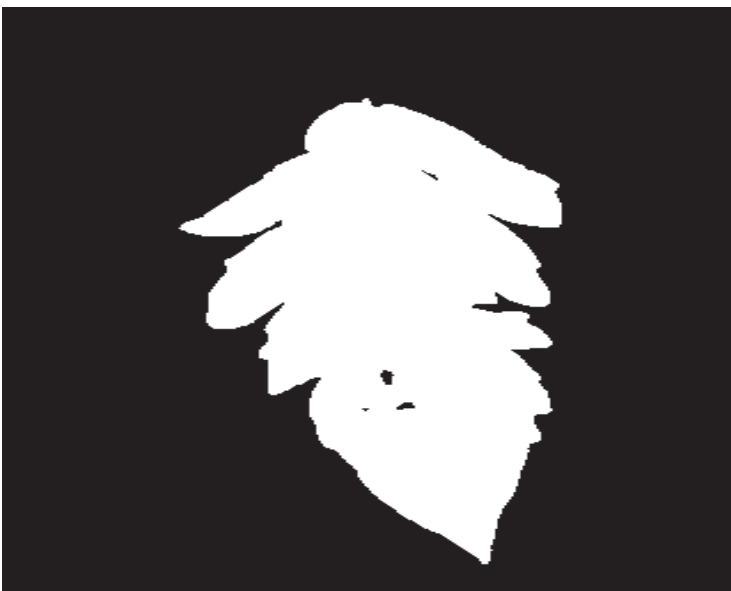
Figuur 7 Gesegmenteerd beeld van een blad, binnen het witte gedeelte is het gemiddelde reflectiespectrum bepaald.
