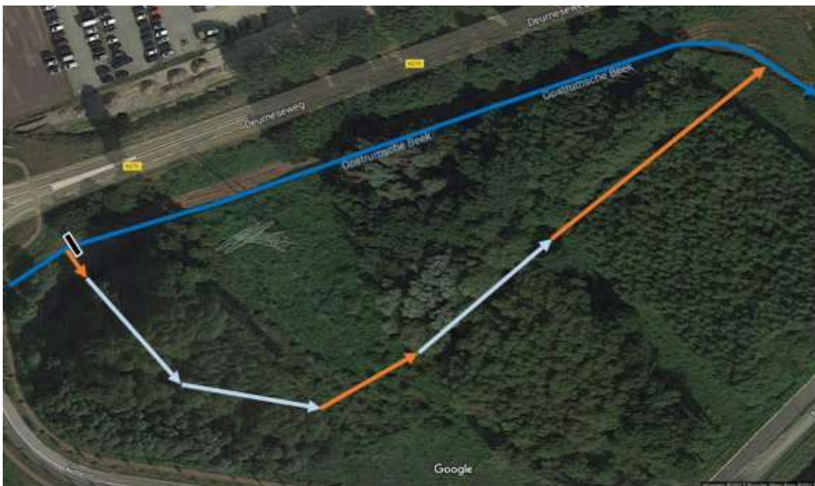
Figuur 1: Vrije afstromingstraject Oostrumsche beek. Oorspronkelijke loop donkerblauw, afgegraven delen oranje, vrije afstroming lichtblauw.
