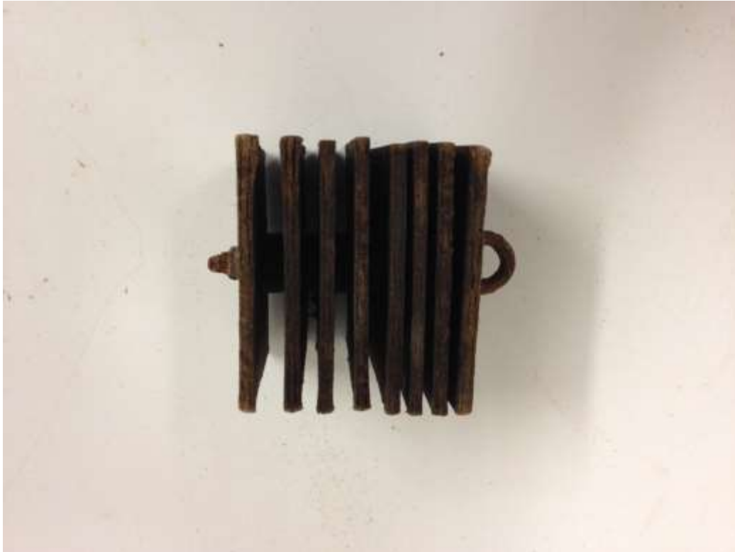
Multiplate sampler (7,5 cm x 7,5 cm x 4 mm plaatjes). De afstand tussen de plaatjes verschilt om dieren van verschillende afmetingen een plek te geven: 3x 3mm, 3x 5mm en 1x 8 mm.
