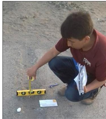
Medición de profundidad de grieta transversal con e > 150mm, con pérdida de material.
