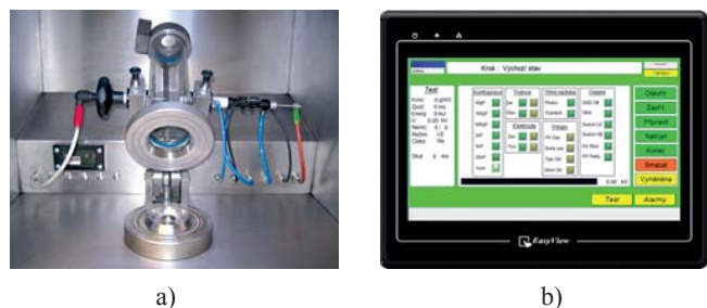
Obr. 4 Zařízení MIE-D 1.2: a) zkušební komora v otevřeném stavu, b) dotykový ovládací panel (Janovský, 2012)
