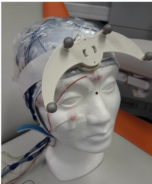
KUVA 13. Muovikelmulla suojattu elektrodimyssy, EOG-elektrodit sekä head tracker -panta aseteltu potilaalle
