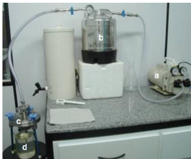
Figura 17. Sistema de filtração a vácuo ( Millipore ), constituído por uma (a) bomba a vácuo, (b) recipiente para acondicionamento do volume de água da amostra e (c) local para inserção da membrana. Também é possível visualizar a amostra após filtração (d).
