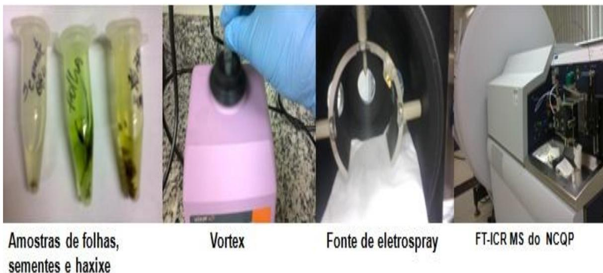
Figura 30 Extração com solvente de amostras de semente, folha e haxixe em microtubos (ependorfes). Vortex Mixer auxiliando na agitação para melhor extração. Fonte de eletrospray, em detalhe, nuvem de solvente acetonitrila. Aparelho de FT-ICR MS do Núcleo de Competências Químicas em Petróleo, localizado no Laboratório de Petroleômica e Química Forense, na Universidade Federal do Espírito Santo – UFES.
