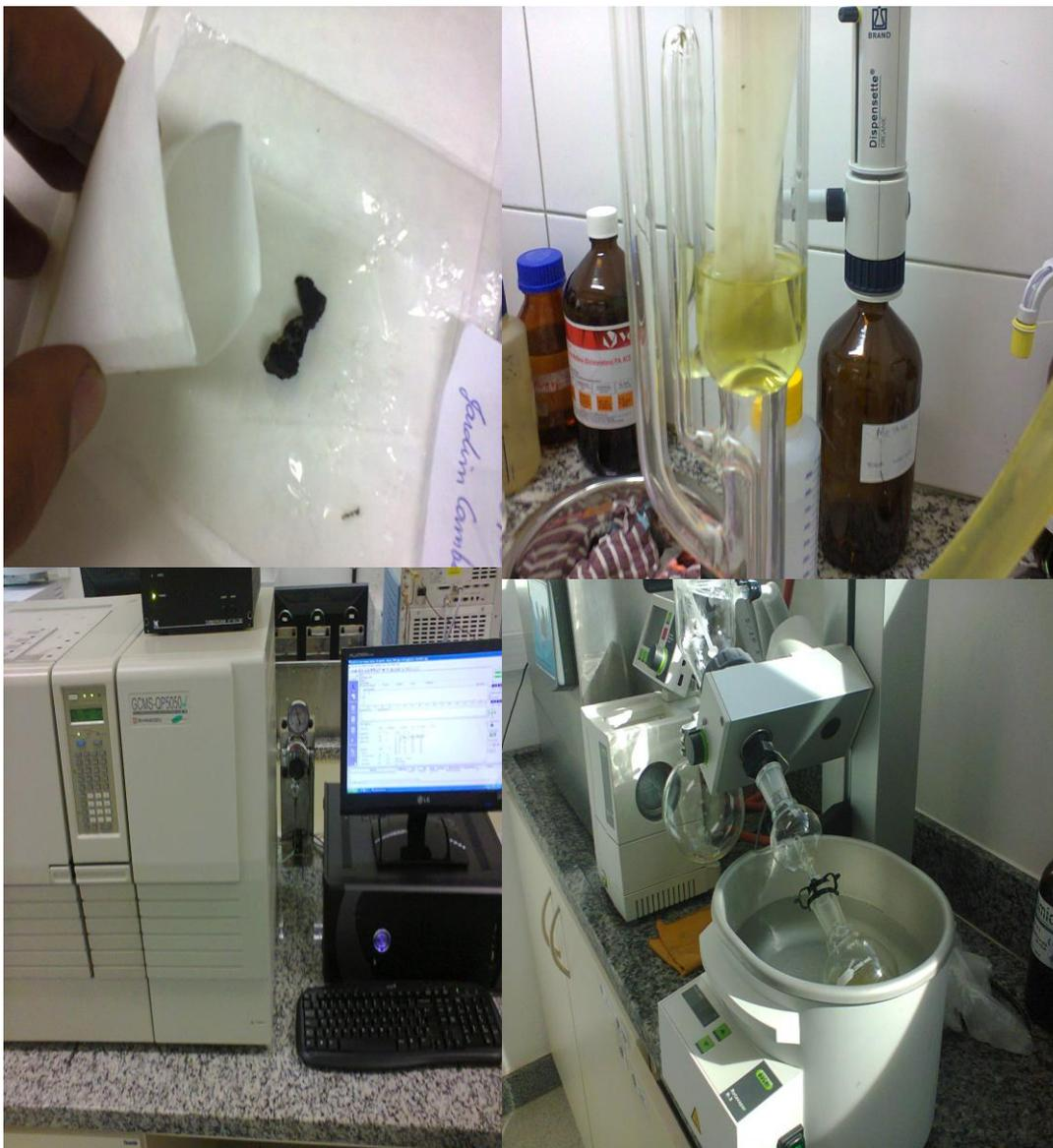
Figura 32 Em sentido horário: Amostra de haxixe (apreensão realizada na região da Grande Vitória; Extração de haxixe em éter de petróleo por método Soxhlet; Rota-evaporador para concentração do extrato e recuperação do solvente; Cromatógrafo a gás (NCQP).
