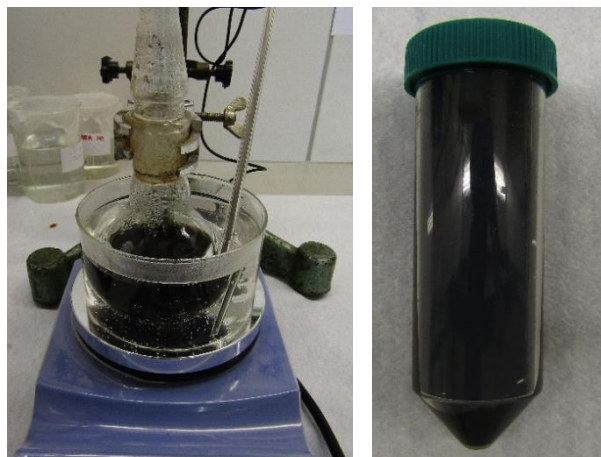
Slika 4-2. Sintetizirani \gamma -Fe 2 O 3 -CA nanodelci
