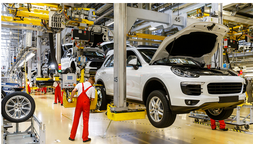
Abbildung 2.3: Hängebahn zur Rädermontage bei Porsche im Werk in Leipzig (Quelle: Porsche AG (2016))
