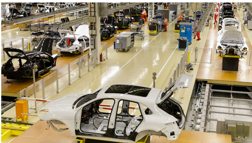
Abbildung 2.4: Interieurlinie mit Schubplattformen bei Porsche im Werk in Leipzig (Quelle: Porsche AG (2016))
