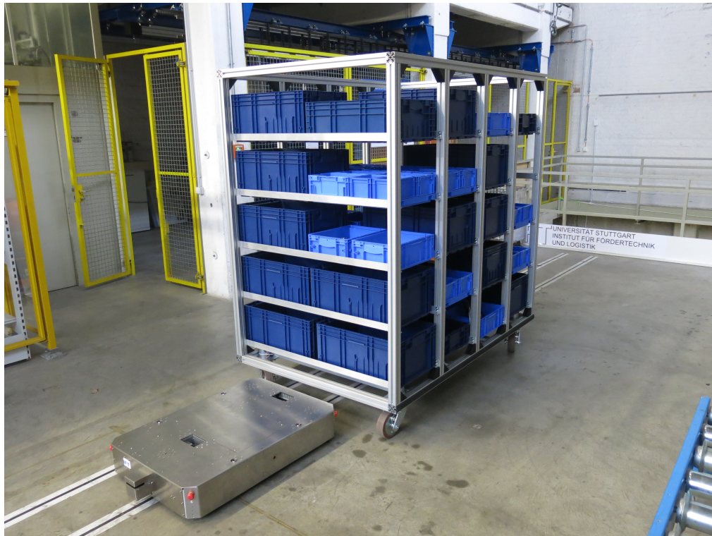
Abbildung A.1: Beladenes Riegelgestell und Unterfahr-FTF (eigene Darstellung)
