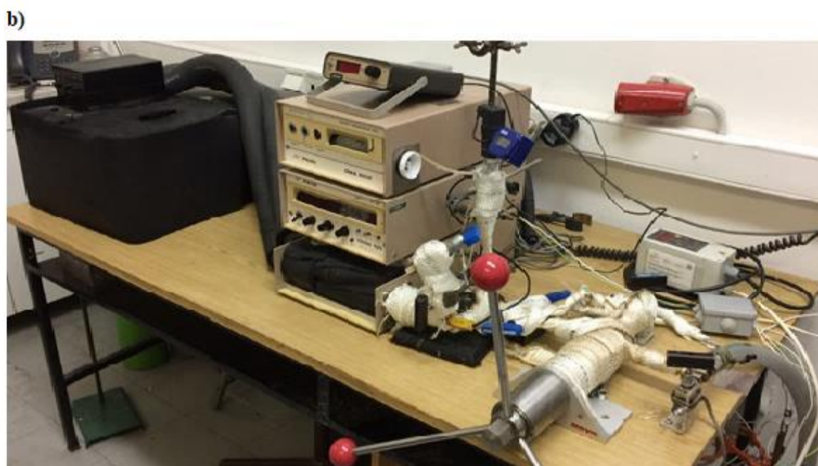
Slika 3-6: Naprava za določanje gostote a) shema in b) fotografija.
