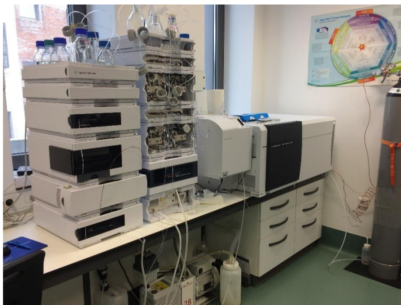
Slika 3-10: Analitska naprava za tekočinsko kromatografijo z masnim spektrofotometrom.
