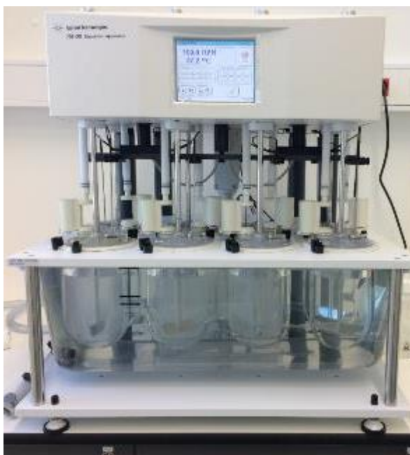
Slika 3-14: Naprava za določanje hitrosti raztapljanja substanc.
