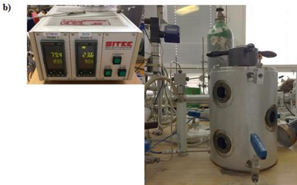
Slika 3-7: Naprava za določanje medfazne napetosti a) shema in b) fotografija.
