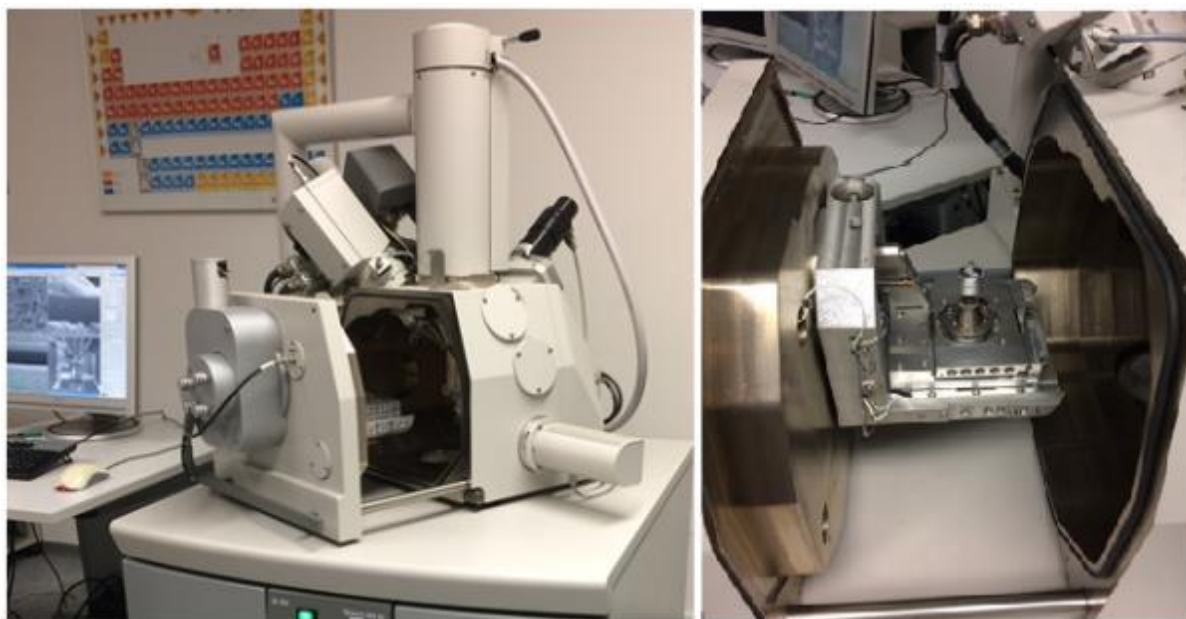
Slika 3-13: Naprava ESEM z odprto komoro za določanje morfoloških lastnosti vzorcev.
