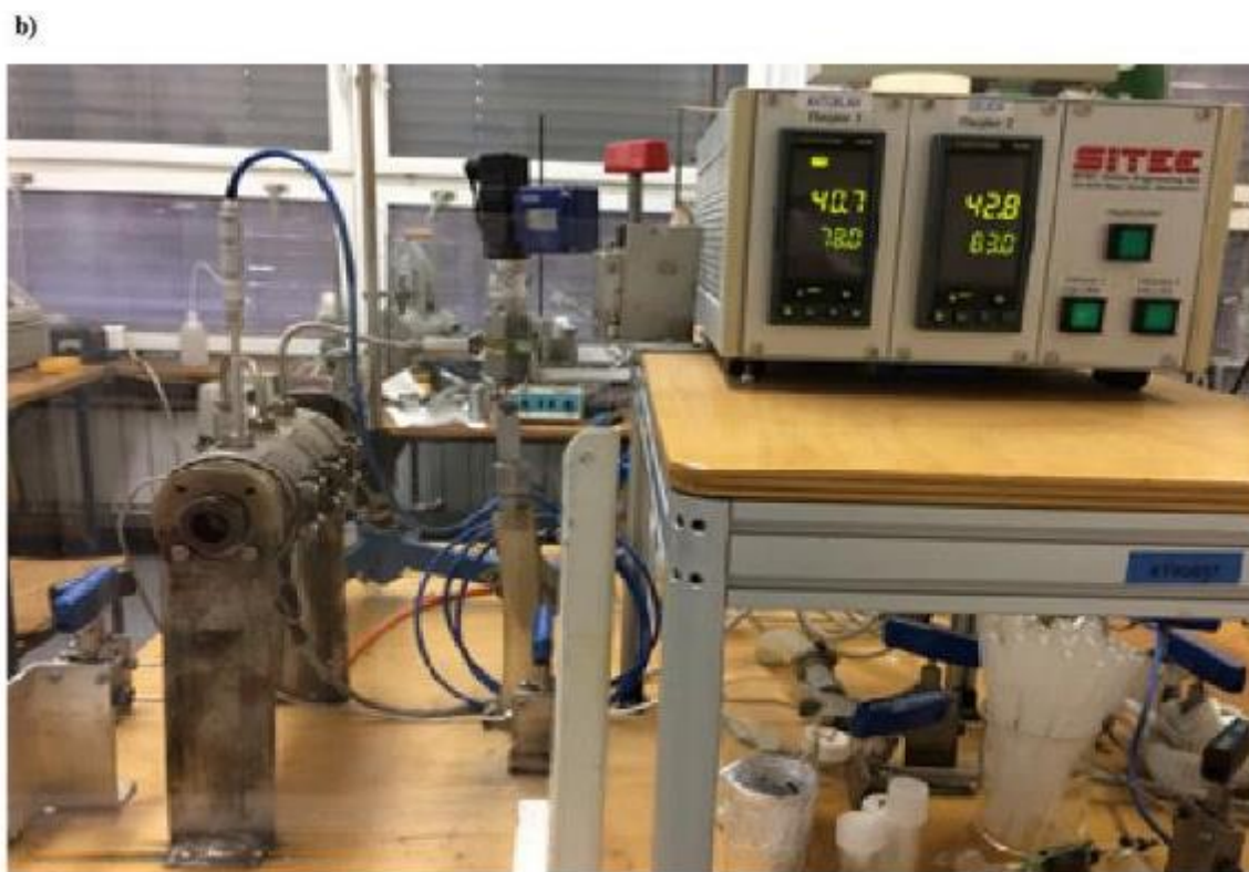
Slika 3-1: Naprava za določanje tališč a) shema in b) fotografija.
