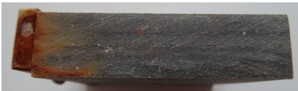
ABBILDUNG 68: QUERSCHNITTSRISSE IM MATERIAL NACH KLIMAWECHSELTEST
