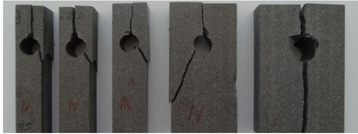
ABBILDUNG 43: VERSAGENS-BILD DER QGB-STECKSCHRAUBVERBINDUNG MIT ZUNEHMENDEM W/D-VERHÄLTNIS AM BEISPIEL DES BOLZENDURCHMESSERS D_1 = 10 MM
