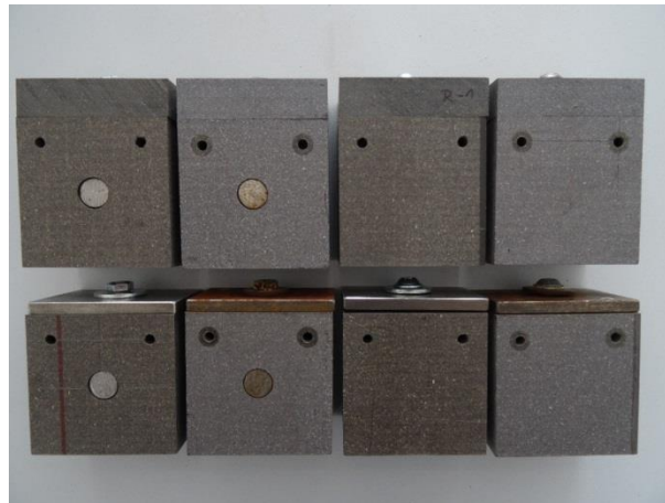
ABBILDUNG 64: SCHRAUBVERBINDUNGEN IM REFERENZKLIMA (OBEN) UND NACH DER 15-WÖCHIGEN UV-GLOBALBEWITTERUNG (UNTEN, MIT SICHT AUF BEWITTERUNGSSEITE)
