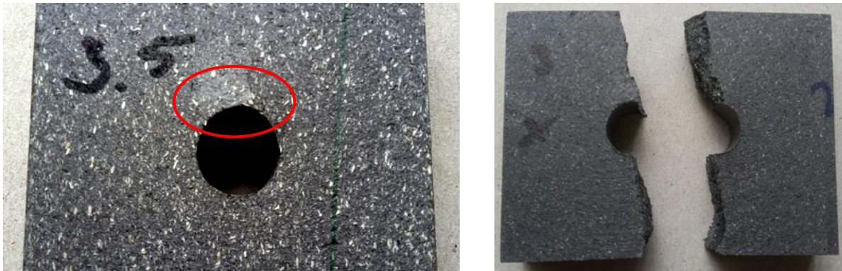
ABBILDUNG 19: LOCHLEIBUNGSVERSAGEN BEI F_{MAX} (LINKS) NACH ÜBERSCHREITEN F_{MAX} (RECHTS) SPALTBRUCH
