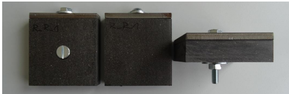
ABBILDUNG 56: AUFBAU DER GETESTETEN SCHRAUBVERBINDUNGEN IN DEN VERSUCHEN KALTWASSERLAGERUNG UND KLIMAWECHELTEST. EINSCHRAUBRICHTUNG ESV SPE, EINSCHRAUBRICHTUNG DSV P-SE, PROBEKÖRPERGEOMETRIE 60 X 60 X 15 MM
