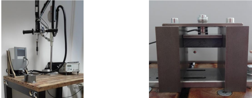
ABBILDUNG 30:VERSCHRAUBUNGSPRÜFSTAND MIT SCHRAUBSPINDEL BOSCH REXROTH (LINKS) UND PROBEINEINSPANNUNG FÜR MONTAGEVERSUCHE (RECHTS)
