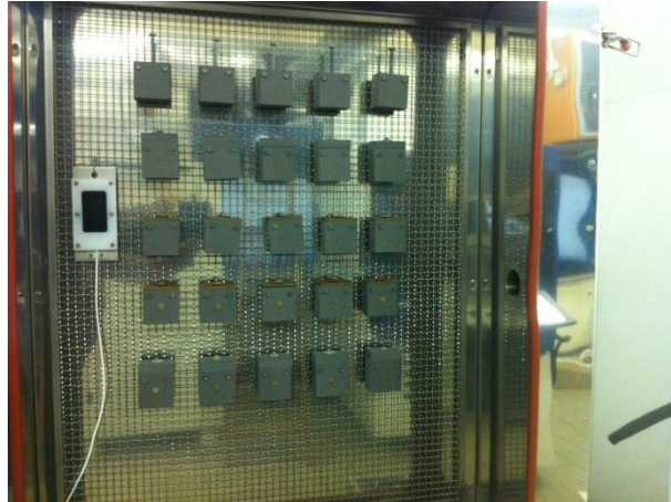
ABBILDUNG 63: ANORDNUNG DER PROBEN IM UV-GLOBALBEWITTERUNGSSCHRANK, LAMPENKOMBINATION NACH EN ISO 4892-3
