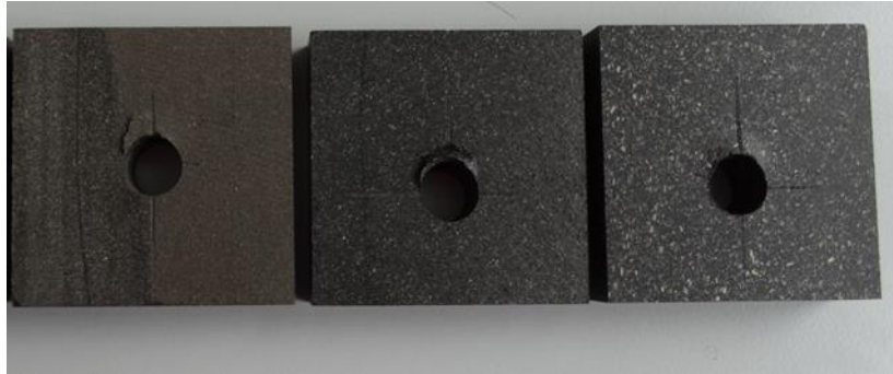
ABBILDUNG 47: LOCHLEIBUNGSVERSAGEN DER PROBEN IM ÜBERDREHVERSUCH WPC-5, WPC-1, WPC-6 (V.L.N.R.)
