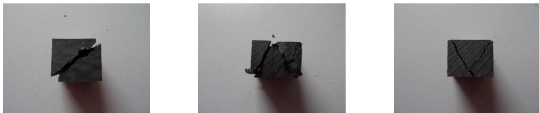
ABBILDUNG 16: VERSAGENSVERHALTEN DRUCKPROBEN WPC-5 IN DEN RICHTUNGEN P-SE, S-PE, S-SE (V.L.N.R.)
