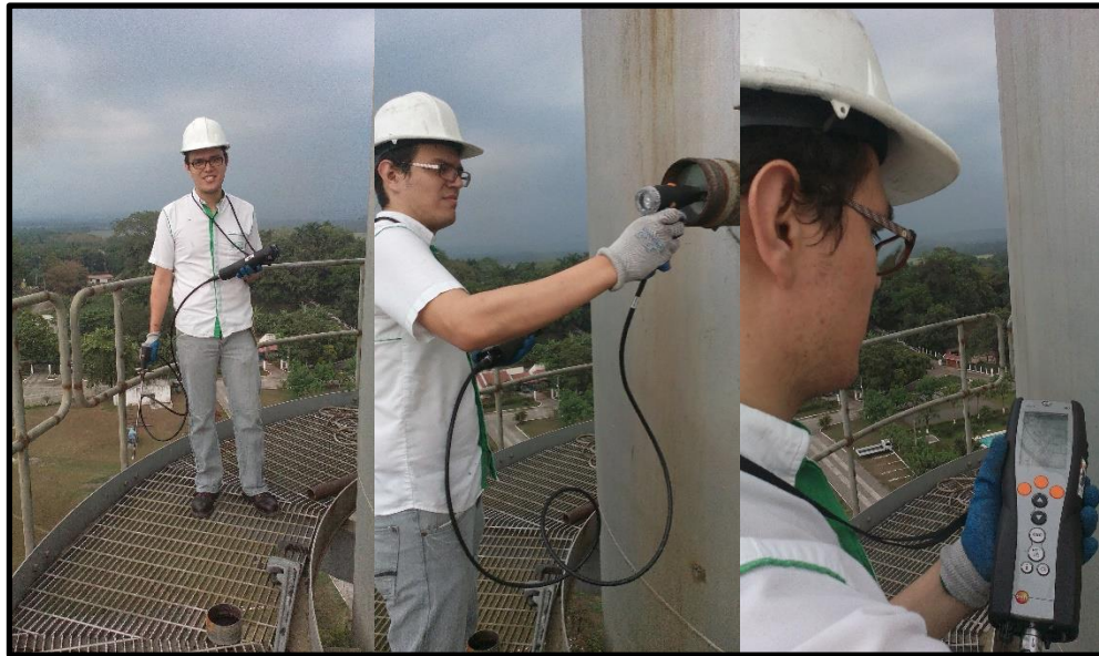
Figura 3. Proceso de toma de muestras en la chimenea del ingenio
