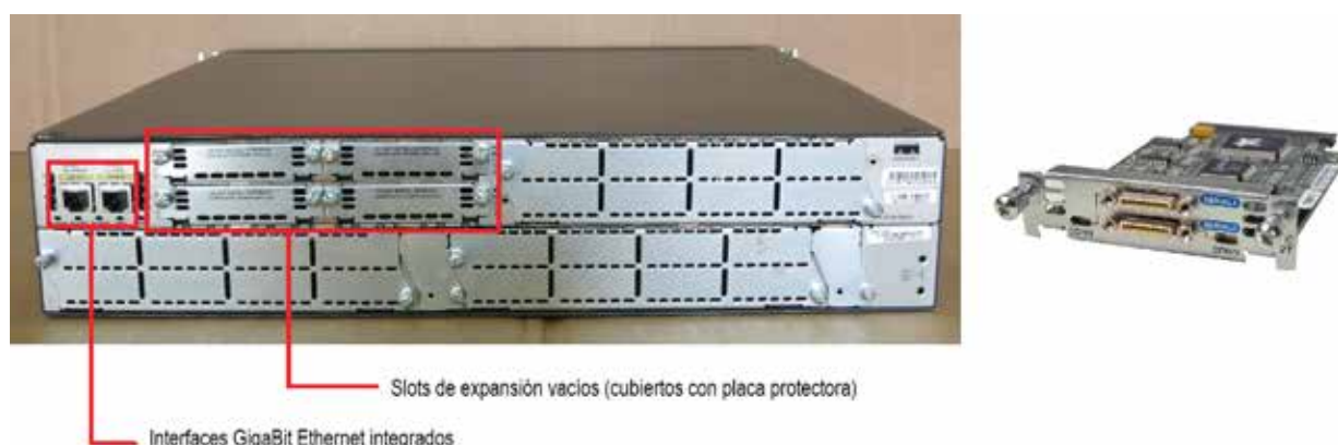
Detalle de los slots de expansión de un Cisco 2821 y tarjeta WIC instalable
