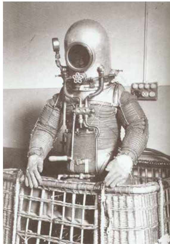
Traje estratonutico, instalado en la barquilla.
