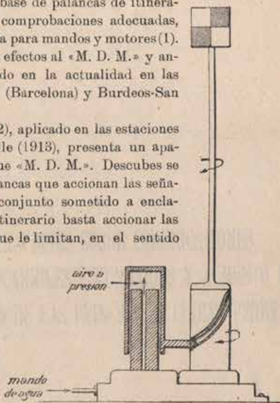
Fig. 17.—Motor de señal.—Esquema.
