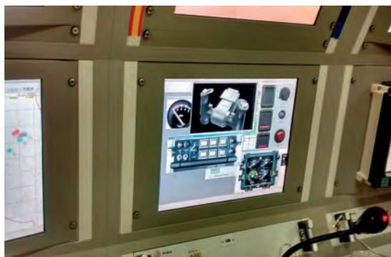
*Pantalla de la UGA con instrumentos de los tripulantes en el simulador individual*
