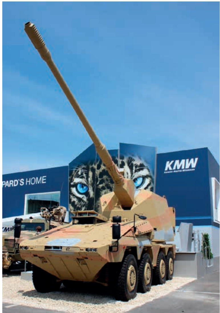
Pieza ATP diseñada con un chasis Boxer 8x8 y una torre de altas prestaciones AGM dotada de un tubo de 155/52 mm.
