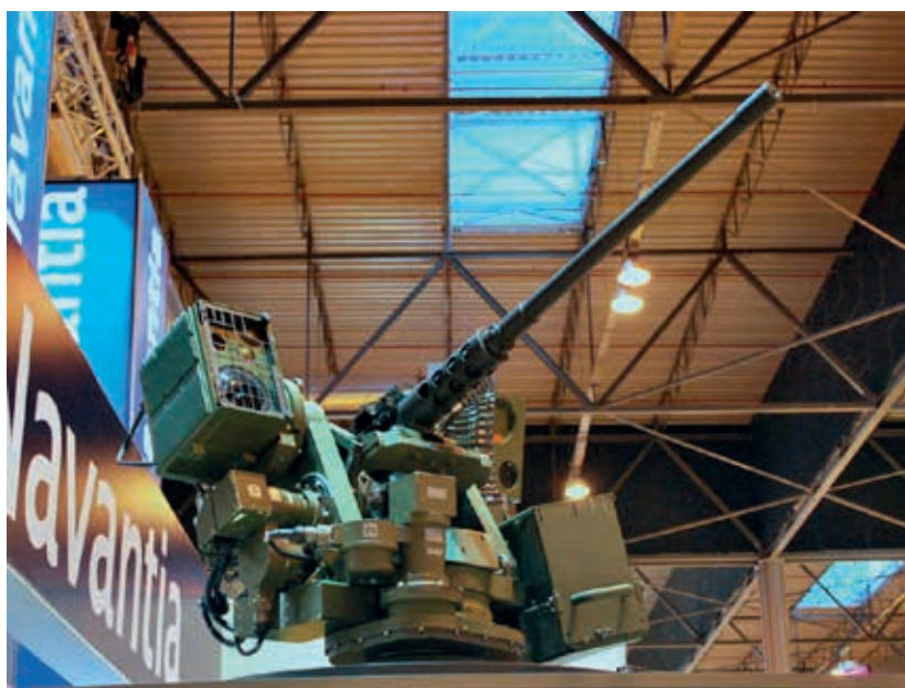
Estación de armas de control remoto Hitrole Light. La gama de estaciones de armas también es muy amplia.
