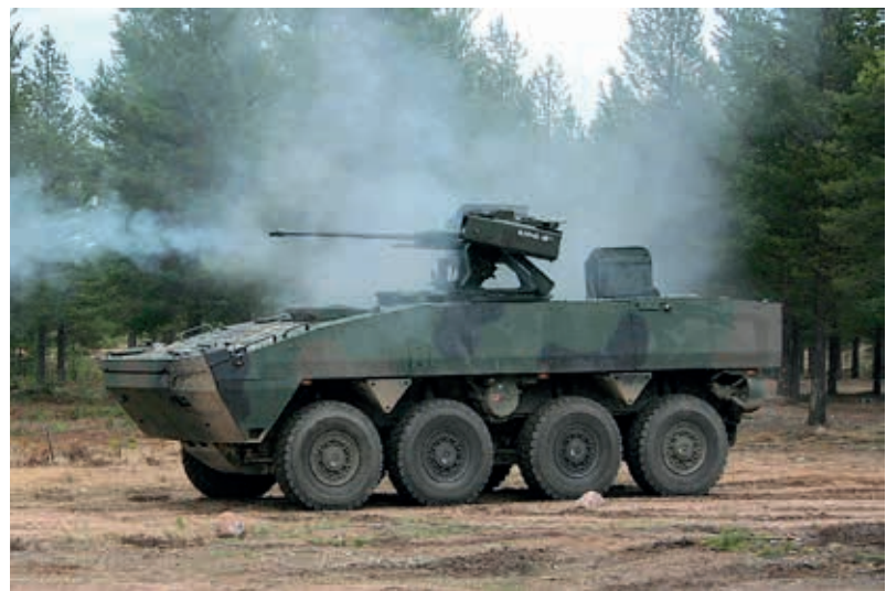
Los VCI/C deben contar con un potente cañón que les permita batir objetivos muy diversos. En la imagen, un AMV con una estación de armas Rafael Samson Mk I.
