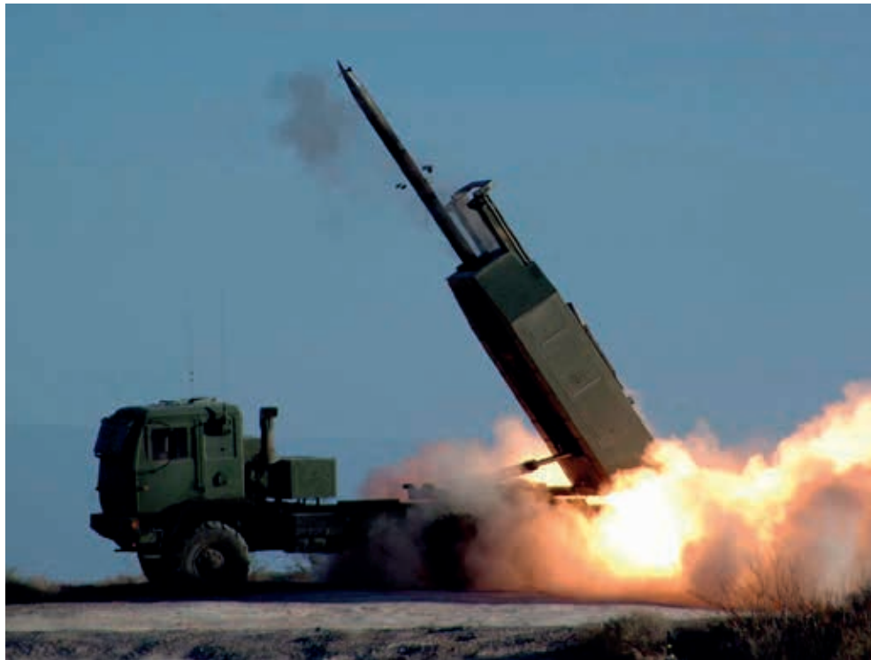
El lanzacohetes HIMARS se ha derivado del MLRS, aunque solo monta un módulo de lanzamiento con seis alvéolos.
