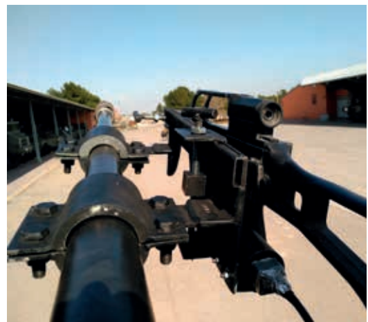
Sistema coaxial de tiro sobre HK.
