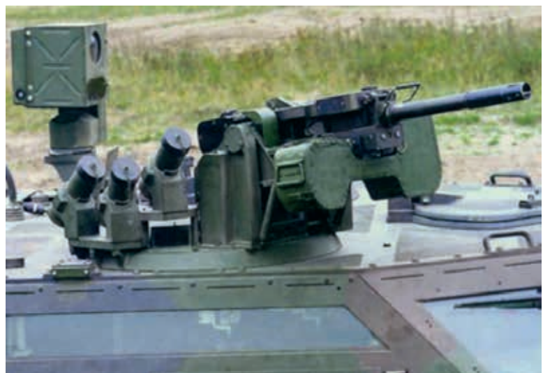
El Fennek germano-holandés monta una estación de armas con un lanzagranadas automático de 40 o una ametralladora de 7,62 mm.
