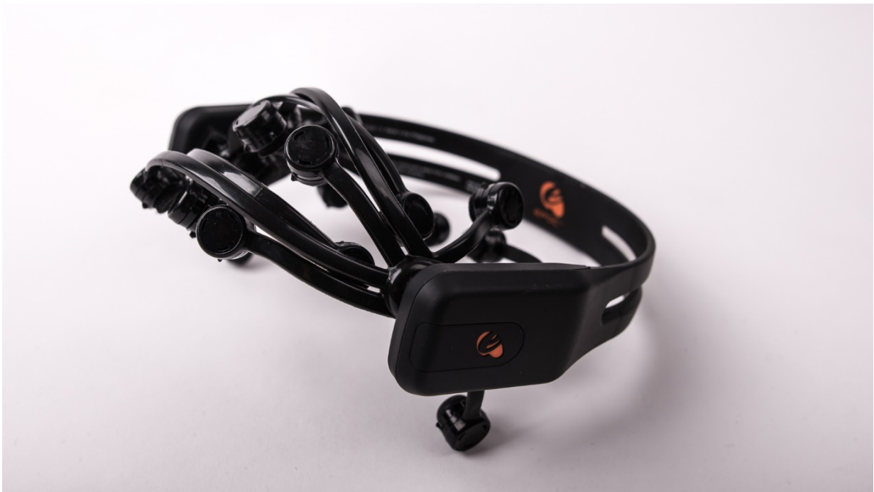
Figure 15 - Emotiv EPOC EEG Headset
