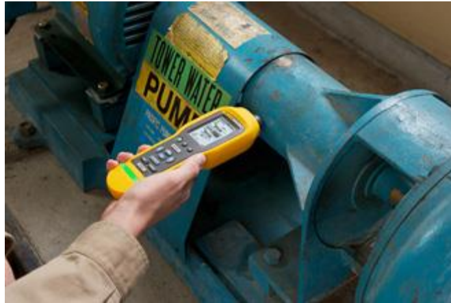
Figura 2.1: Esquema de medición de vibración directamente sobre equipo. Fuente: Fluke.
