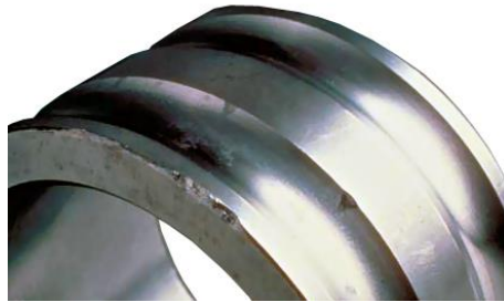
Figura 2.5: Daño por defecto de montaje. Fuente: http://www.blogmecanicos.com .
